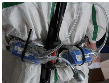
Figure 1. Equipement d'un opérateur Cassettes de prélèvements Pompes de prélèvement individuel
