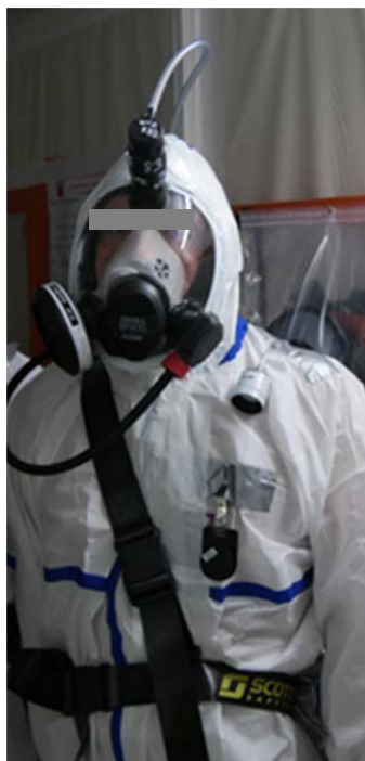
Figure 1. Equipement d'un opérateur Cassettes de prélèvements Pompes de prélèvement individuel
